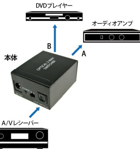
※1台の光デジタル対応機器の入力情報を最大2つの機器に切換
