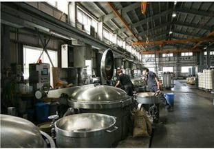
ひとつの釜で1日に2～3色染めていきます。釜には150kgもの量が入り、その釜が工場の中には100個程設置されているとのこと。染め上がったら別の釜に移動させ乾燥させます。機械が多く、熱を発生するため、夏は室温が50度くらいになるそうです。
